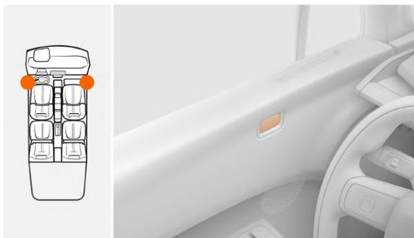
**Apertura:** Para abrir la puerta delantera, pulse la tecla del panel embellecedor de la puerta mientras la empuja hacia fuera.
