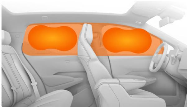
Las cortinas de aire para la cabeza están instaladas a lo largo de ambos lados del techo y se extienden hasta la protección del pilar A para proteger a los pasajeros sentados en los asientos exteriores. Los paneles embellecedores están marcados con la palabra "AIRBAG".
