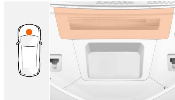
4 Utilice herramientas para cortar el dispositivo de corte de cable de emergencia.
