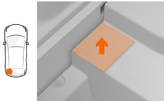
3 Tire del cable de desbloqueo de emergencia en la dirección indicada por la flecha.
