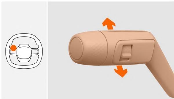
**Encendido:** Cuando el vehículo se pone en marcha y las luces de cruce están encendidas, empuje la palanca hacia adelante una vez para activar las luces de carretera.
