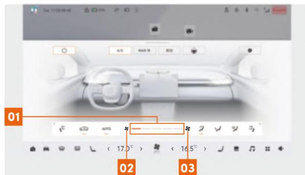
**01** Deslice la barra de flujo de aire para ajustarlo.
