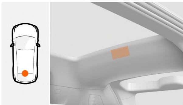
El vehículo puede utilizar los sensores de radar en el techo para comprobar si queda alguien en el asiento trasero después de apagarlo o bloquearlo. Si detecta algún pasajero, emitirá una alarma para recordarle que debe asegurar su seguridad.
