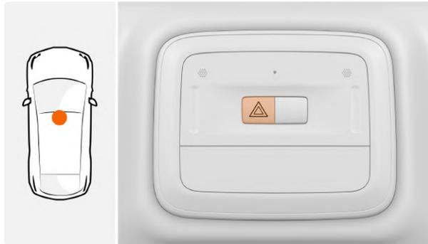
Para encender las luces de advertencia de emergencia cuando el vehículo se encuentra con un accidente de tráfico o una situación de emergencia, puede pulsar la tecla de las luces de advertencia de emergencia.
