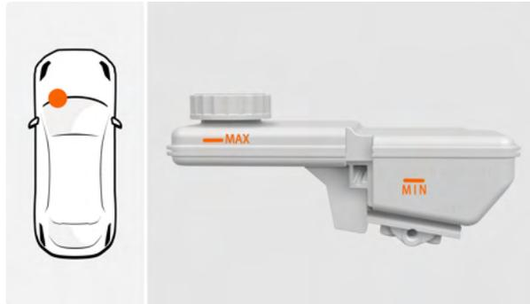
Verifique periódicamente el nivel de líquido de frenos para asegurarse de que esté entre las marcas yMAX. MIN
