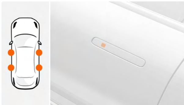
**Desbloqueo :** Cuando el vehículo está bloqueado, acérquese al vehículo con la llave Bluetooth o la llave Bluetooth de la aplicación de ZEEKR y toque el área de inducción en la manija de la puerta exterior para desbloquear el vehículo.
