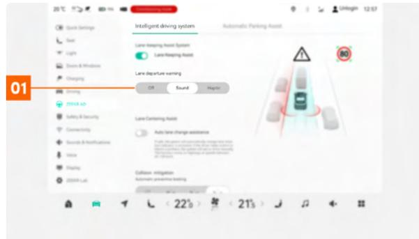
**01** Toque el botón para activar o desactivar el LDW. Configure los métodos de advertencia de salida de carril (Apagado, Sonido, Háptico).
