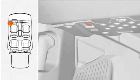
El enchufe OBD-II se encuentra debajo del panel de instrumentos izquierdo, en el lado del conductor.
