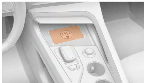
Después de desbloquear el vehículo con la llave de tarjeta NFC, usted puede presionar el pedal del freno para poner en marcha el vehículo dentro de los 10 minutos. Después de más de 10 minutos, deberá colocar la llave de tarjeta NFC en el área de inducción para poner en marcha el vehículo.
