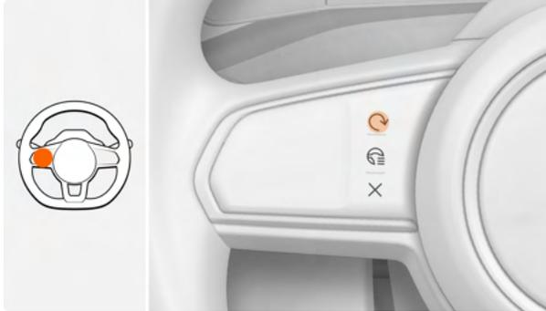
Presione y suelte el botón
