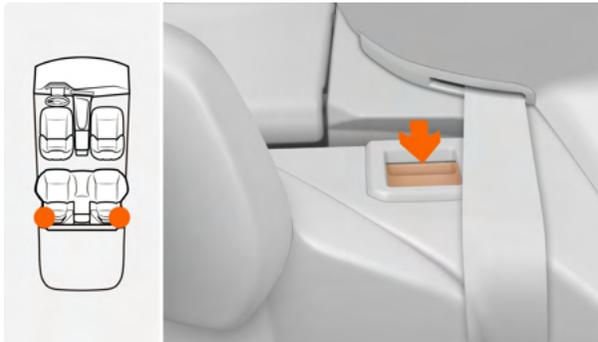
El dispositivo de bloqueo se encuentra en la parte exterior de los reposacabezas traseros
