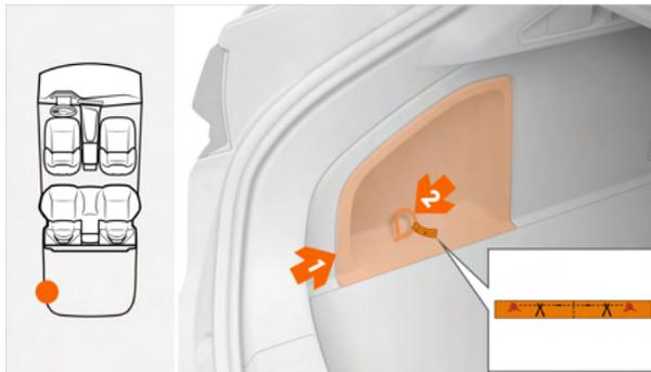
El dispositivo de corte de cables de emergencia está ubicado detrás del panel izquierdo del maletero.
