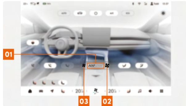
**01** Arrastre el deslizador de volumen de aire para ajustar el volumen de aire.
