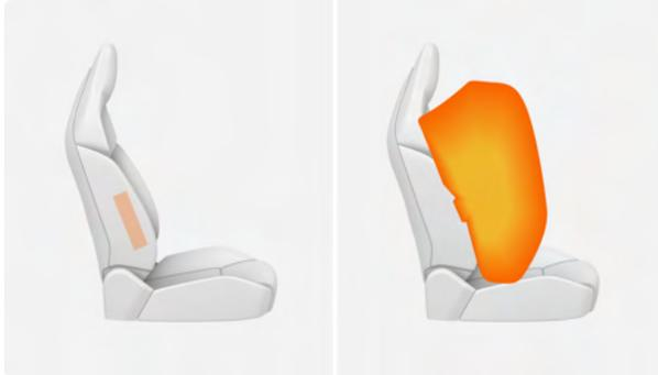
La bolsa de aire lateral remota está instalada en el lado derecho del asiento del conductor, e indicada con la marca "AIRBAG".
