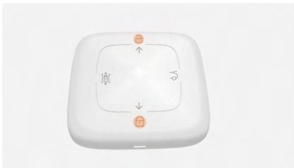
**Botón de bloqueo:** Pulse y suelte el botón de bloqueo para bloquear todas las puertas y el portón trasero, y activar la alarma antirrobo.
