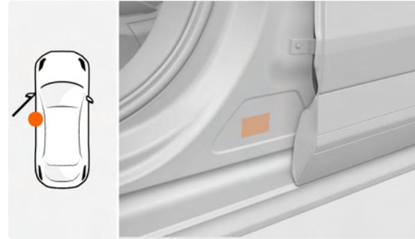
Revisar regularmente la presión de los neumáticos, especialmente antes de viajes largos. Consulte los datos técnicos mostrados en la etiqueta de presión de los neumáticos (ubicada en el pilar B del lado del conductor) para conocer las especificaciones recomendadas de presión de los neumáticos.
