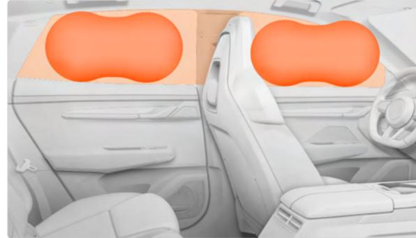
Las cortinas de aire de seguridad para la cabeza están instaladas a lo largo de ambos lados del revestimiento del techo, protegiendo a los ocupantes que se sientan en los asientos exteriores. Los paneles embellecedores están marcados con la palabra "AIRBAG".
