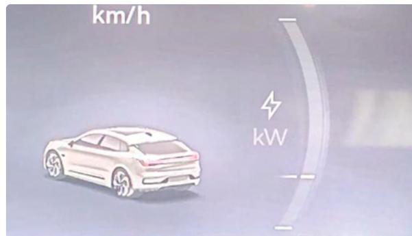
Cuando el sistema de frenado regenerativo está funcionando, el grupo de instrumentos muestra la información de potencia del frenado regenerativo.
