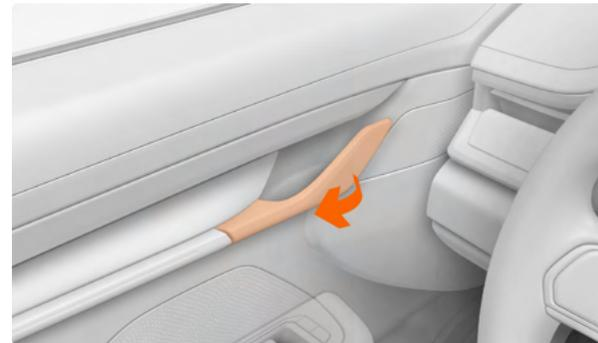
**Abrir:** Tire de la manija de la puerta interior y empuje hacia afuera para abrir la puerta.
