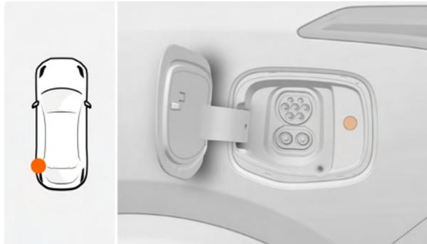
El indicador LED muestra diferentes colores según el estado de carga *Carga con el equipo de carga a bordo* (p. 270).
