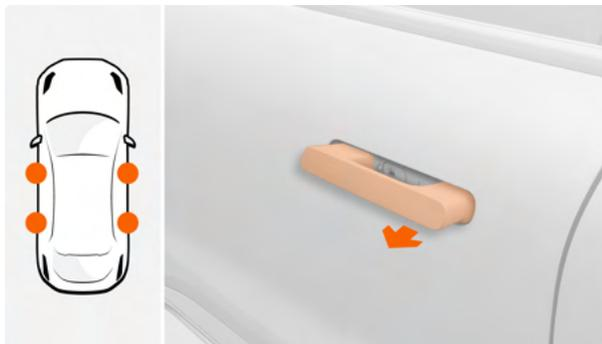
**Abrir:** Una vez desbloqueado el vehículo, el tirador exterior de la puerta saltará hacia arriba. Tire de el tirador exterior para abrir la puerta.
